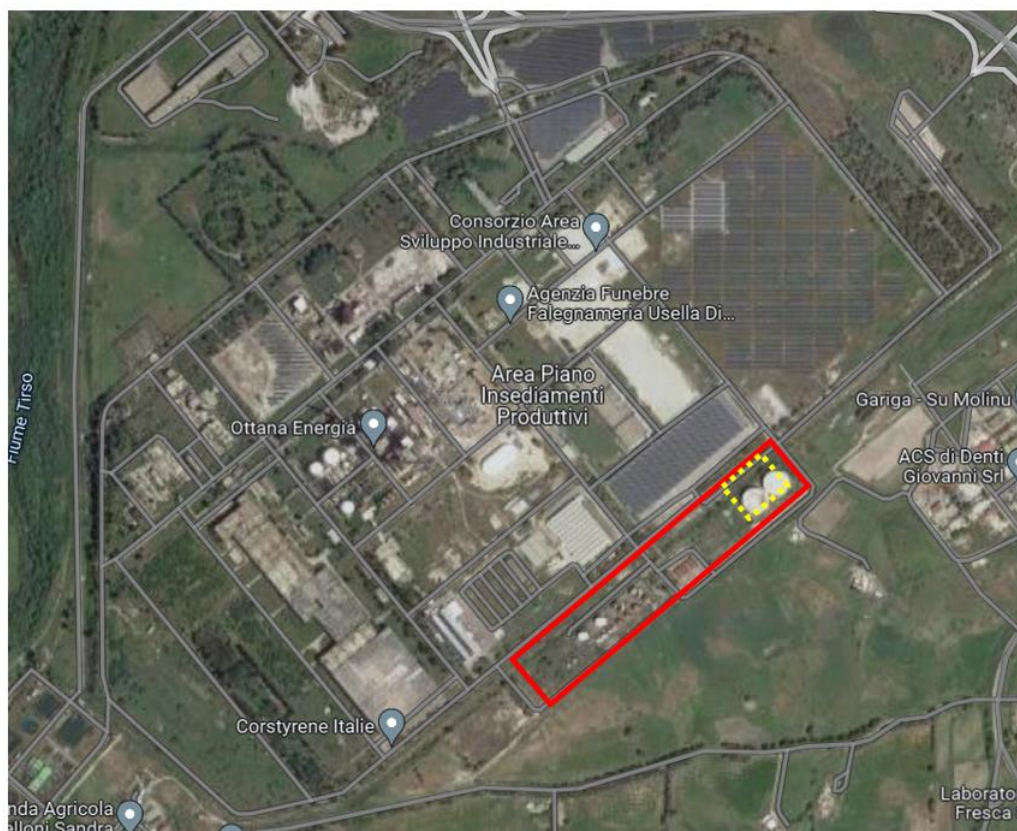
Figura 44 – Layout di cantiere con individuazione dell’area per il posizionamento della gru in giallo
